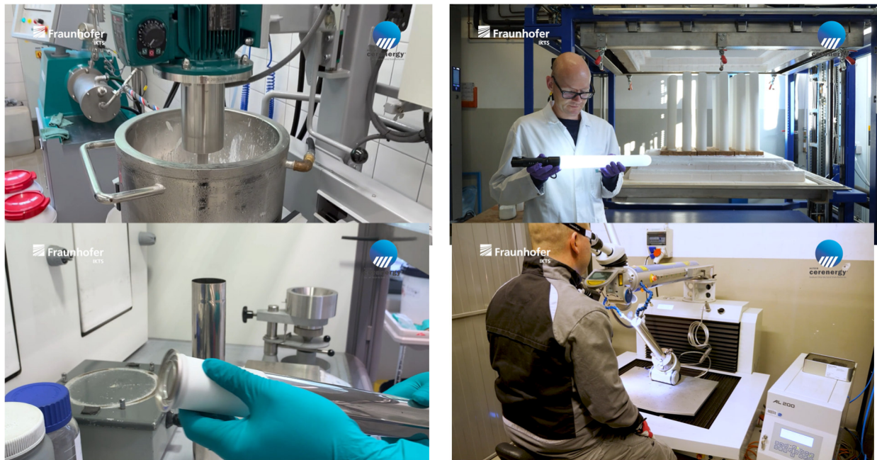
Abbildung 34 – Produktion der Prototypenzellen in der Pilotline des IKTS Hermsdorf
