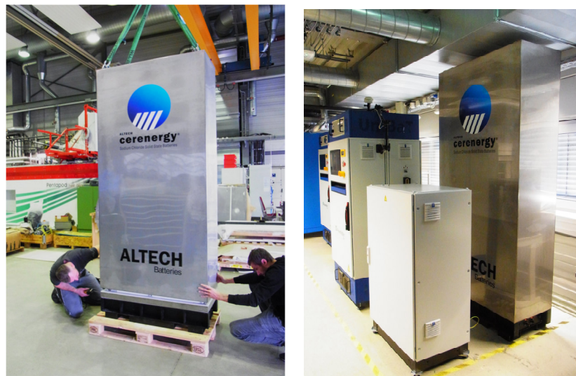
Abbildung 36 – Anlieferung der Batteriegehäuse und Vorbereitung für thermische Tests
