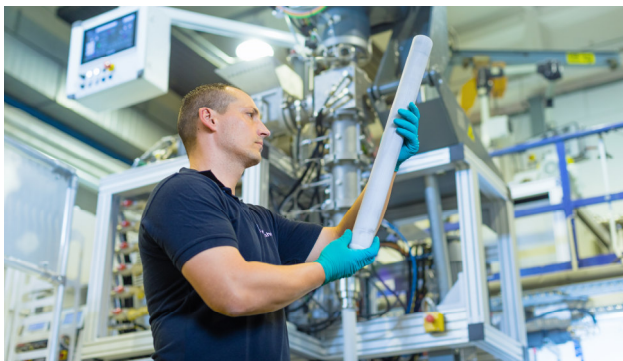
Abbildung 5 – keramischer Feststoffelektrolyt in der Pilotlinie
