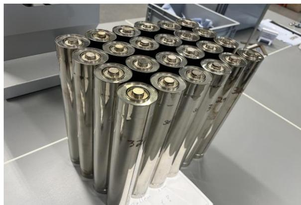
Abbildung 35 – Fertiggestellte Prototypenzellen bereit für den Teststand
