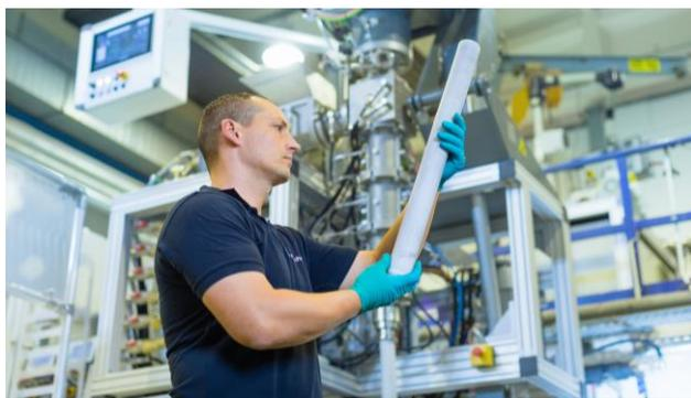
Abbildung 5 – keramischer Feststoffelektrolyt in der Pilotlinie
