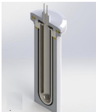
Abbildung 8 - Querschnitt der CERENERGY-Batterie
