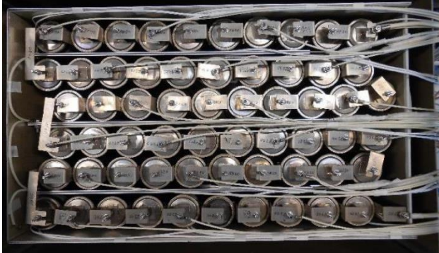
Abbildung 9 – Konfiguration der Zellen im Batteriemodul
