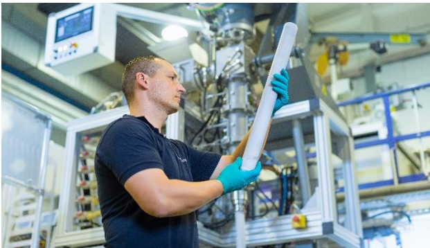
Abbildung 4 – Keramischer Festkörperelektrolyt in der IKTS Anlage
