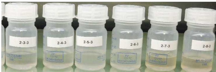
Bild 3: Elektrolytproben mit Verfärbungen - von links nach rechts: 4N-Aluminiumoxid (99,99%), 3N-Aluminiumoxid (99,9%), Böhmit (99,7%)
