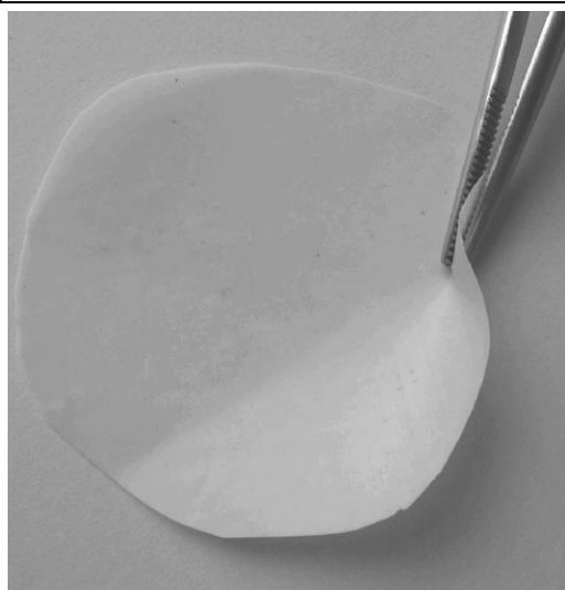
Abbildung 2. Typische PEO-basierte, mit HPA versetzte Nanokomposit-Membran (Armand et al., 2011)
